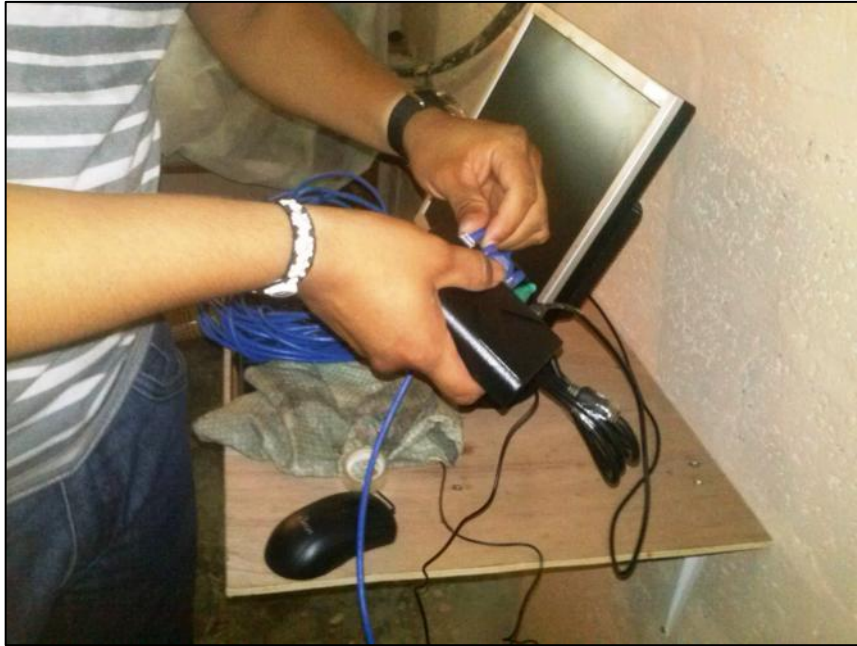
Figura 47: Conectando el cable de red a los terminales Xtenda x300
