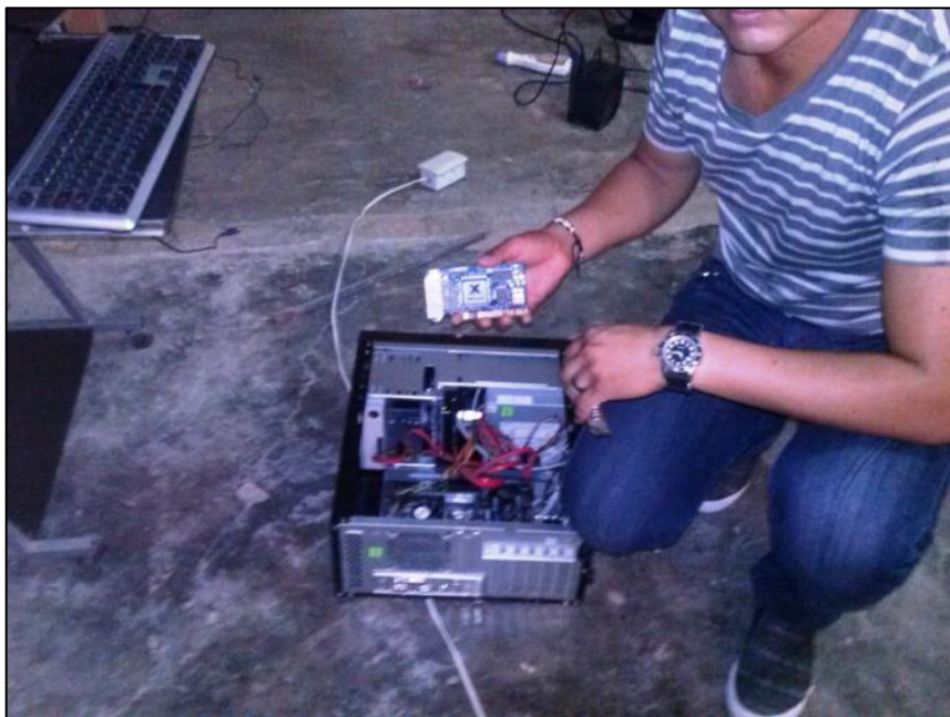
Figura 44: Tarjeta PCI Xtenda x300 a instalarse en la CPU – Servidor
