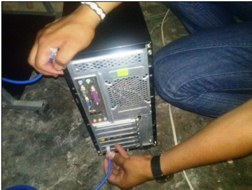
Figura 48: Conectando los cables de red a la tarjeta PCI Xtenda instalada en la CPU
