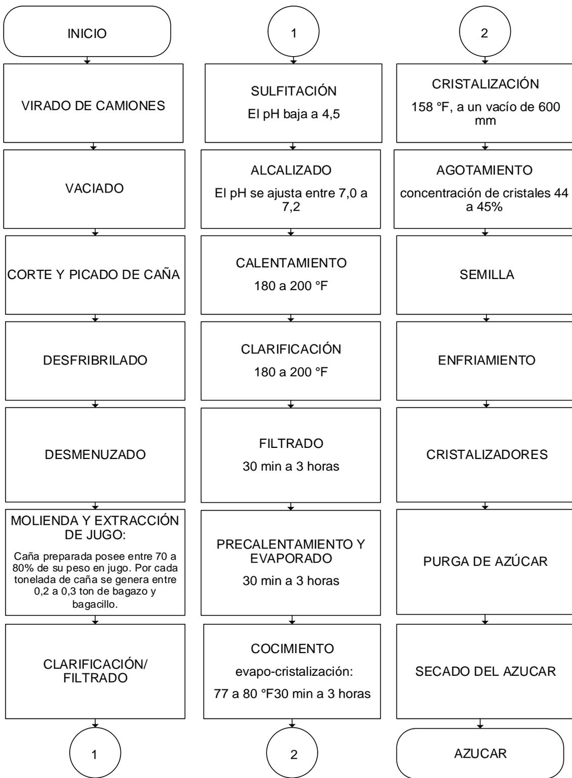
**Figura 1.** Flujograma del proceso industrial de la Azúcar
