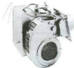
Se utilizan quemadores de bloque cerámico, aptos para altas temperaturas. Son de alta turbulencia, alta relación, alto y bajo fuego y especiales para trabajo pesado. Poseen interruptores de seguridad por baja presión de aire y sistema de monitoreo de llama. Pueden trabajar con combustible diesel o con gas.
