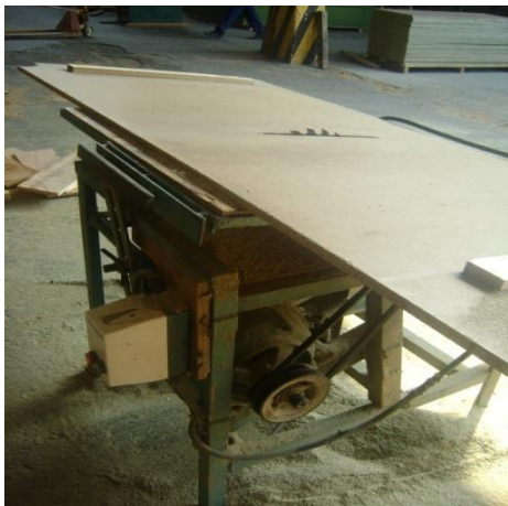
Figura 20. Falta de aspiración y protección en la sierra de mesa. Fuente: Barrezueta – Morán
