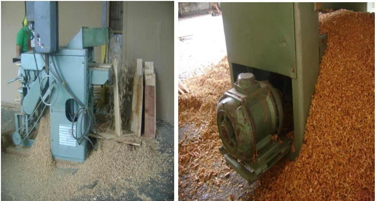
Figura 22. Estudio De La Cepilladora Ausencia De Protección Fuente: Barrezueta - Morán
