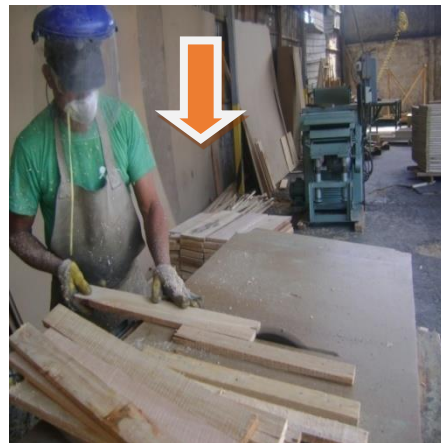
Figura 20. Falta de aspiración y protección en la sierra de mesa. Fuente: Barrezueta – Morán
