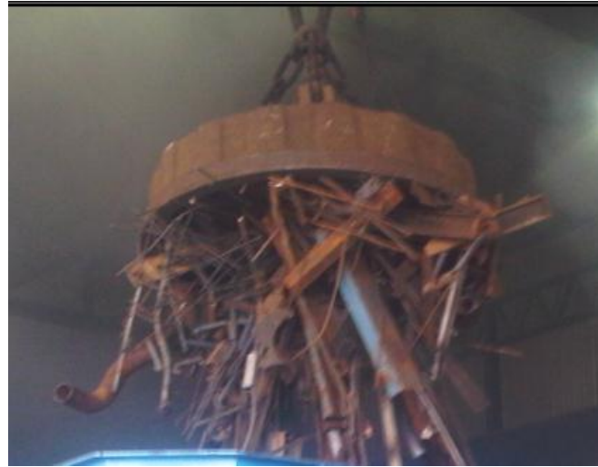
Figura 11 Puente Grúa - Electroimán
