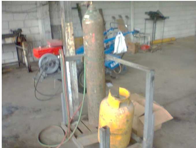
Figura 3. Equipo de oxicorte con cilindro de gas.
