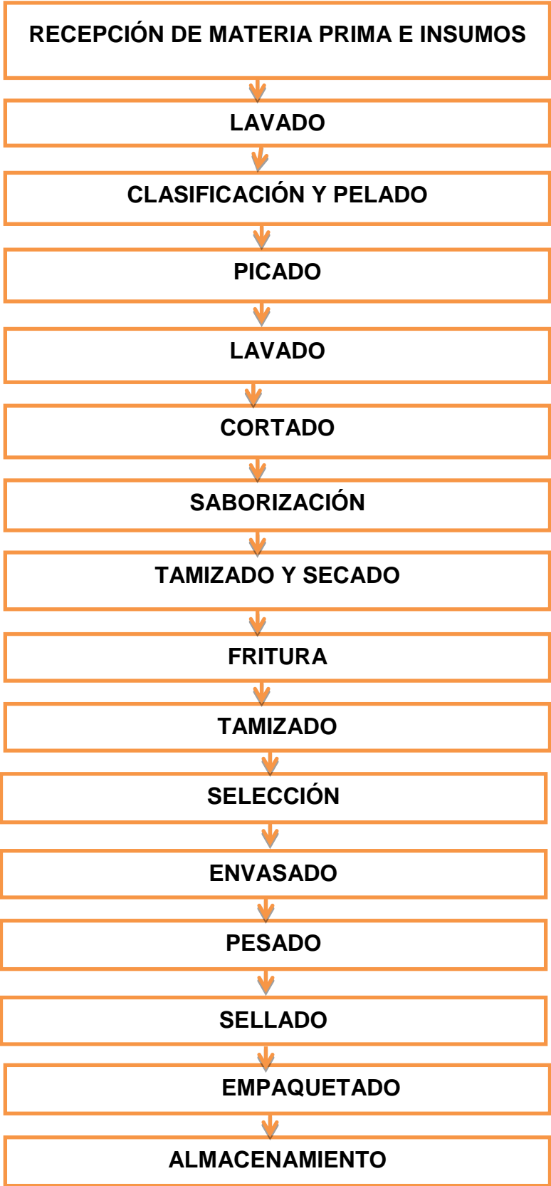
Figura 57. Diagrama de Flujo de la elaboración de snacks de camote y yuca
