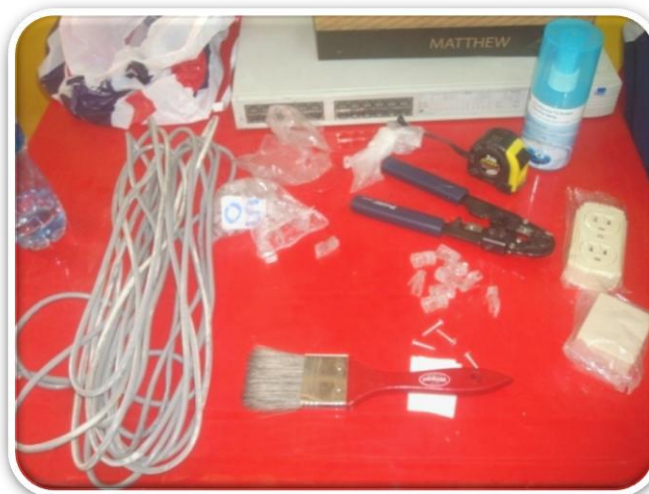
Foto 20. Materiales utilizados para la instalación de la Red LAN.
