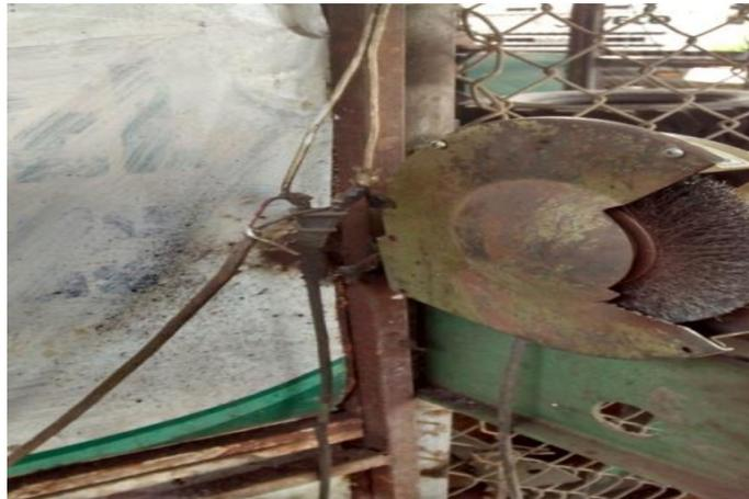
**Figura 3.** Conexión sin protección.
