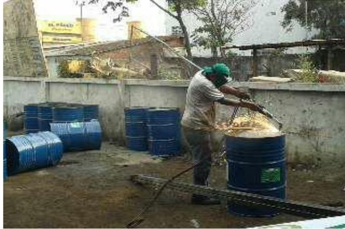
**Figura 7.** Corte de tanques de sustancias toxicas.
