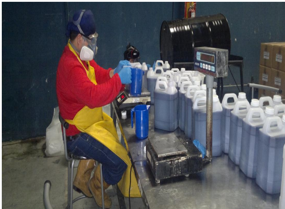
Figura 2. Sobredosificación de producto en envases por falta de calibración de balanzas.
