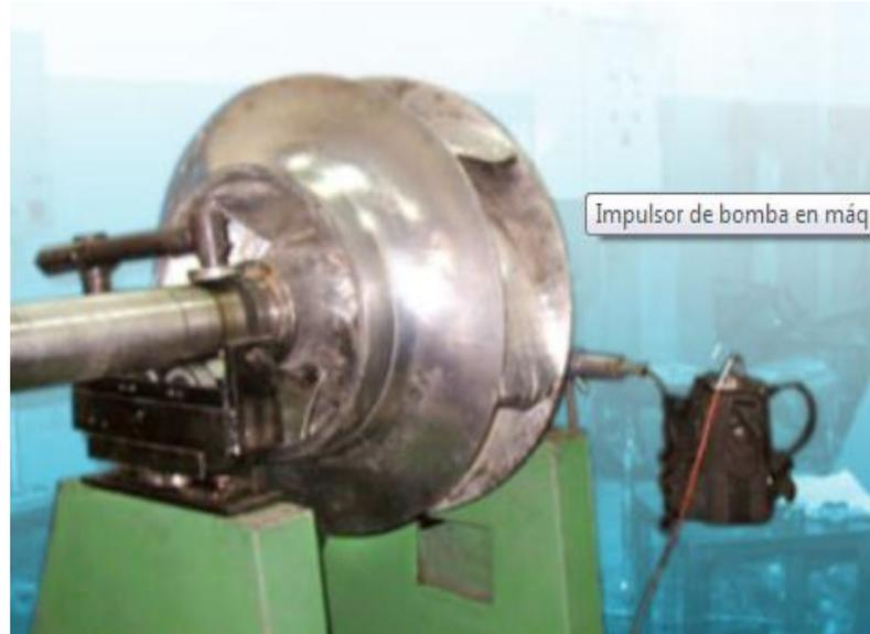
**Figura # 9** Balanceo Dinámico a impulsor de Bomba vertical
