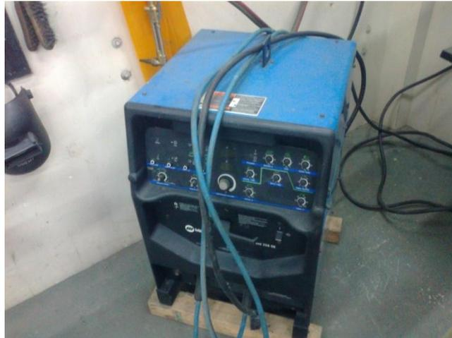
**Figura 5.** Soldador industrial tipo TIG marca Miller Matic.250X
