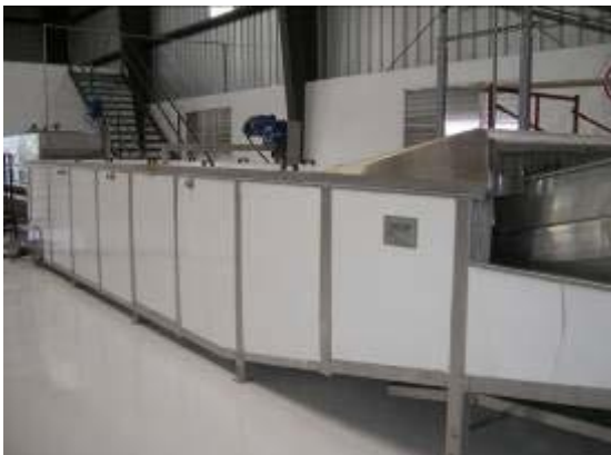
Tratamiento Hidrotérmico a 55oC para Control de Antracnosis.
