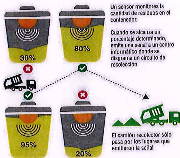
Fig.1 Contenedores con sensores de capacidad
