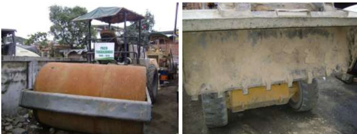
Figura 2.20 Corrosión en rodillo y palas metálicas
