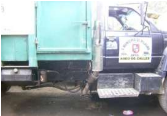
Figura 2.14 Fuga de aceite por válvula principal en la parte lateral.
