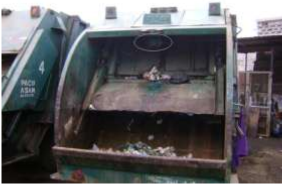
Figura 2.13 Fuga de aceite por válvula principal en la parte trasera.
