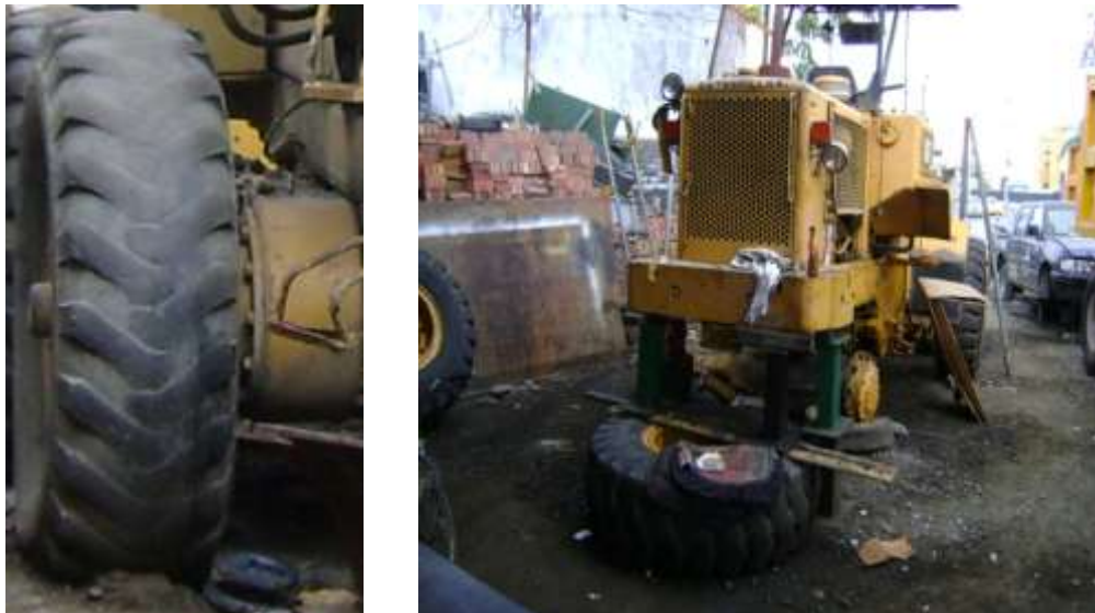
Figura 2.22 Neumaticos en mal estado
