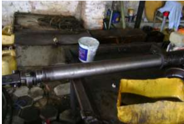
Figura 2.15 Cilindro desgastado, oxidado y falta de cromado
