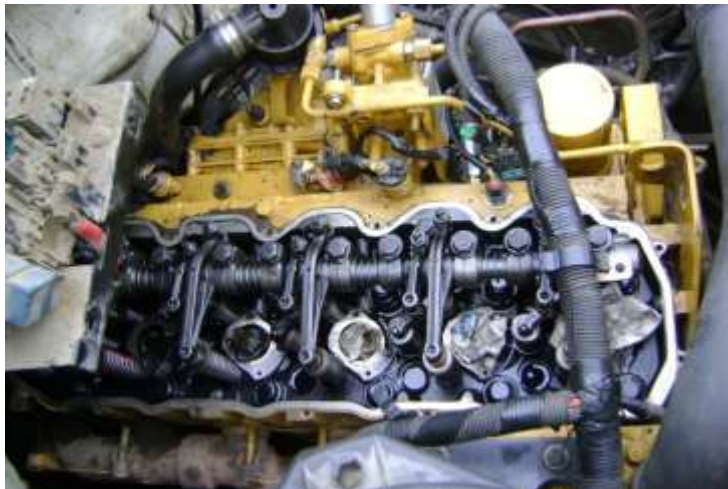
Figura 2.17 Sistema de inyección desmontado y otras partes.
