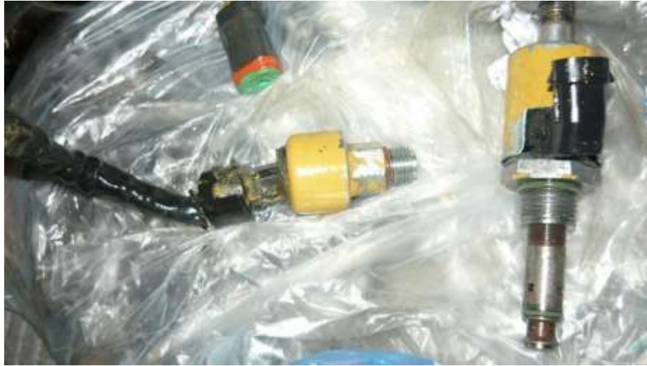
Figura 2.16 Falla en las toberas por diesel sucio y falta de filtrado.
