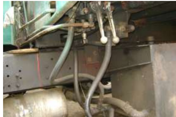
Figura 2.14 Fuga de aceite por válvula principal en la parte lateral.
