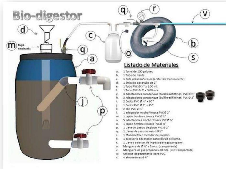
**Imagen 8 Modelo de biodigestor casero**
