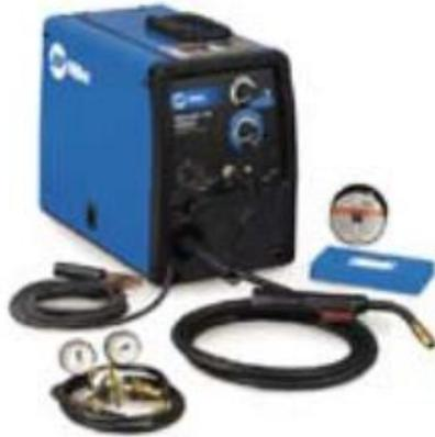
Ilustración 13 Equipo para proceso de soldadura GMAW. Recuperado de:
