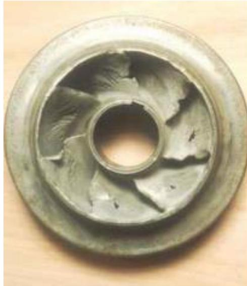
Ilustración 6 Rodete dañado por cavitación. Recuperado en: (Torres, 2016)
