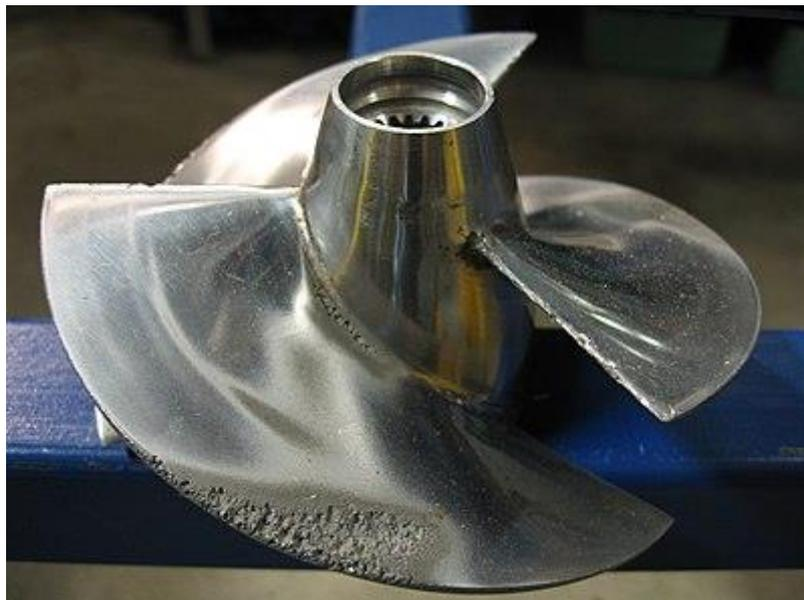
Ilustración 9 Daños por cavitación en álabes de turbinas Francis. Recuperado de: (Torres, 2016)
