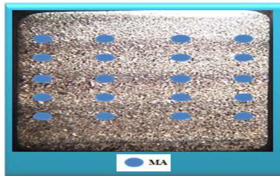
Figura 28 Esquema de indentaciones superficiales sobre los revestimientos soldados
