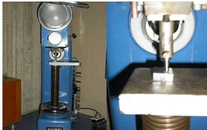
Figura 14 Durómetro con Zoom en el Indentador
