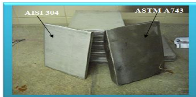
Figura 21 Materiales base (izquierda) AISI 304, (derecha) ASTM A743 grado CA6NM
