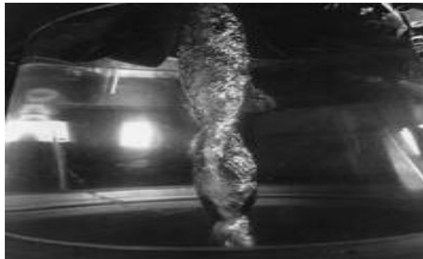
Figura 6 Antorcha observada en banco de pruebas.
