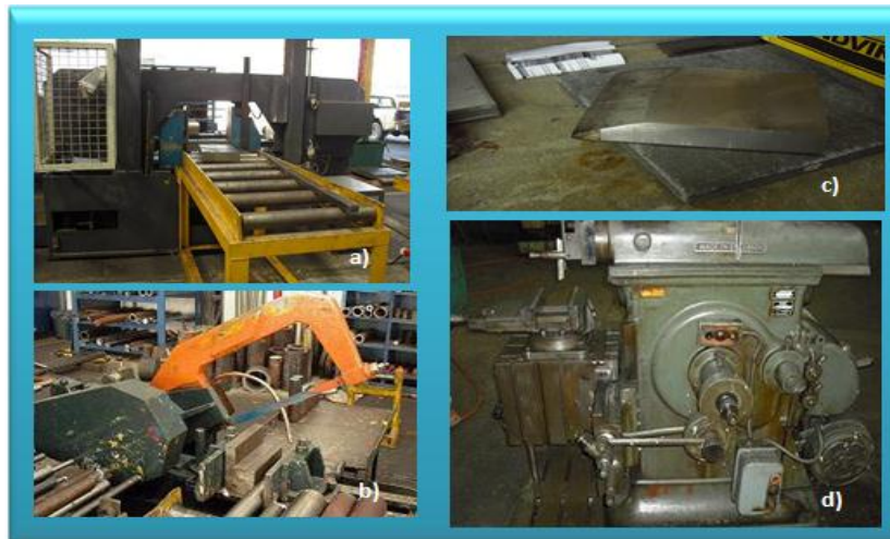
Figura 15 a) Sierra cinta modelo CPS – 440, marca DANOBAT. b) Sierra vaivén, modelo BS – 280 marca KASTO c) Muestra del acero ASTM A743 sin seccionar d) Cepillo.
