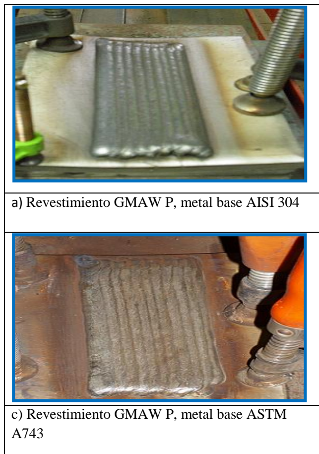
Figura 51 Inspección visual de los revestimientos depositados sobre ambos metales base, mediante transferencia GMAW P.
