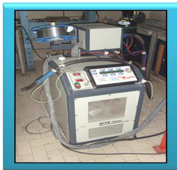
Figura 18 Fuente multiproceso, modelo MTE DIGITEC 450.
