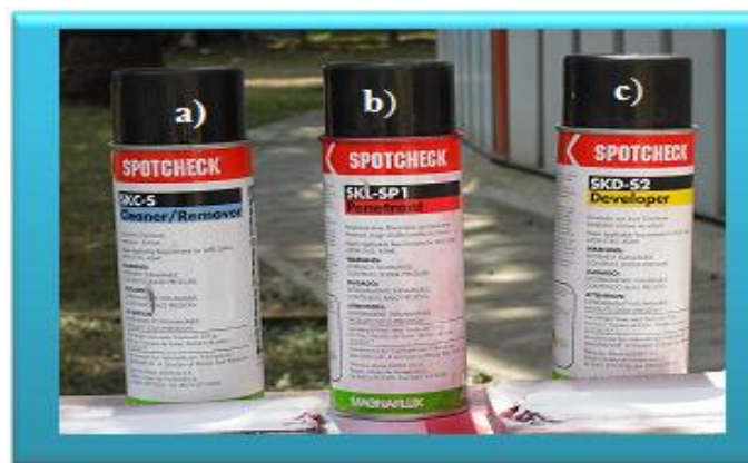
Figura 17 Kit MAGNAFLUX para inspección con líquidos penetrantes; a) SKC-S cleaner, b) SKL-SP penetrant, c) SKD-52 developer.
