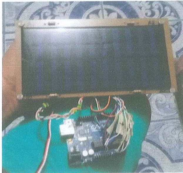
Figura 20. Conexión de las LDR, resistencias fijas y panel fotovoltaico en una placa baquelita
