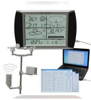
Figura 8. Estación meteorológica con conexión a PC
