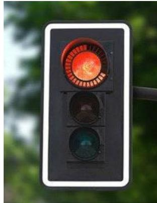
Ilustración 31: Semáforo con temporizador.
