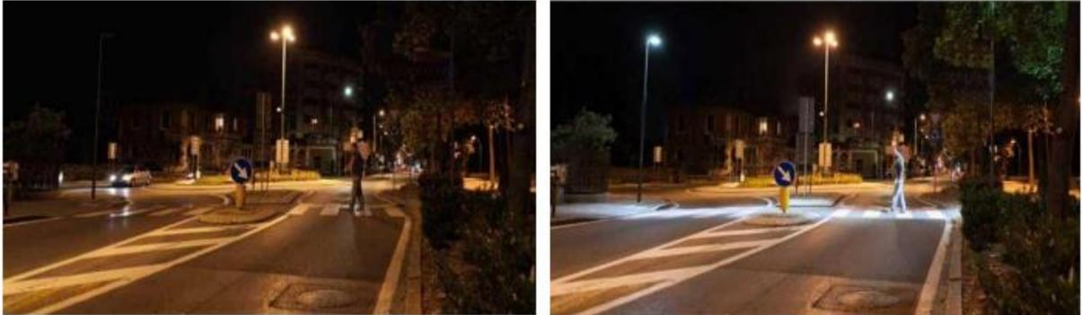
*Ilustración 13: Foco alumbrado con sensores incorporados en un paso cebra.
