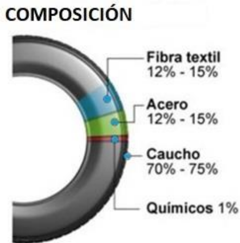
Figura 1. Composición del Neumático
