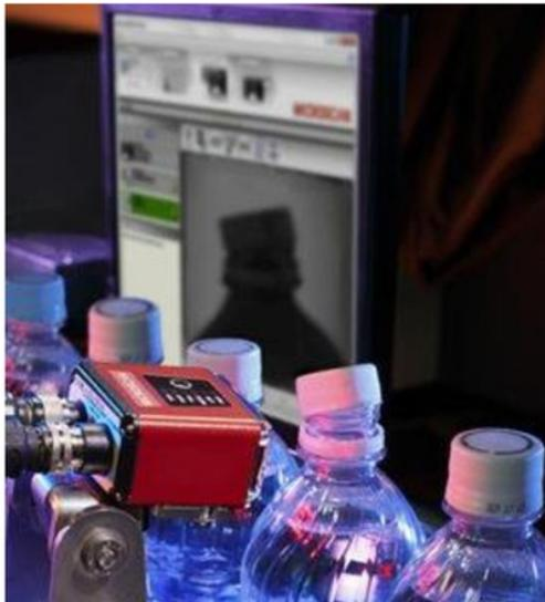
**Figura 2** Aplicación de Visión Artificial para control de calidad en botellas.
