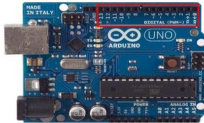
Figura 18 Pines de la placa Arduino a utilizar.
