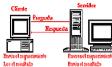
Figura 5: Modelo Cliente-Servidor
