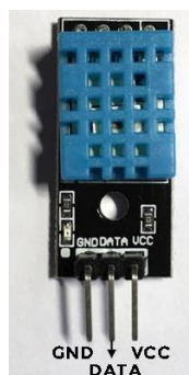
Figura 10. Figura Sensor de temperatura y humedad
