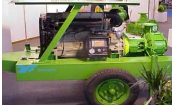
Ilustración 16. Bomba hidráulica perteneciente al grupo horizontal (Madrigal, n.d.)
