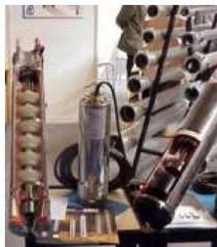
Ilustración 18. Bomba hidráulica perteneciente al grupo sumergible (Madrigal, n.d.)
