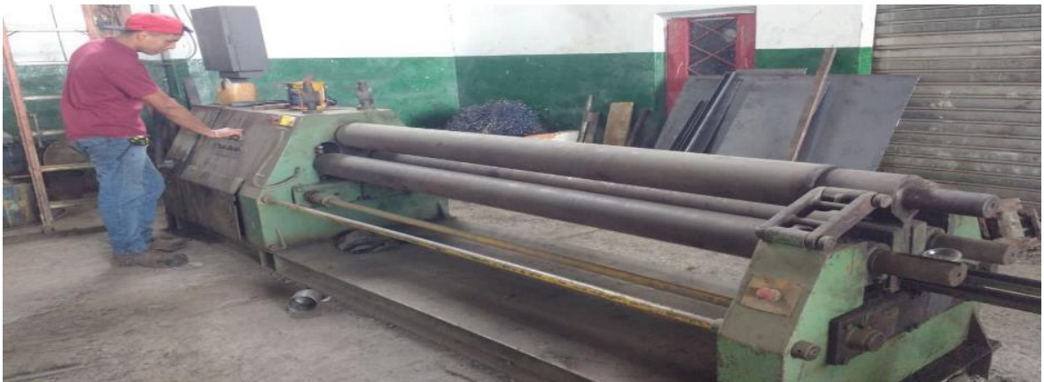
Ilustración 6.- Roladora de laminas
