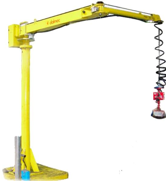
*Ilustración 15. Manipulador Neumático*
