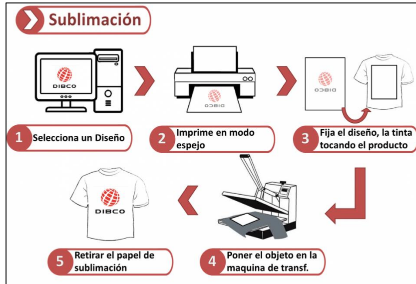
Ilustración 17 Proceso de sublimado
