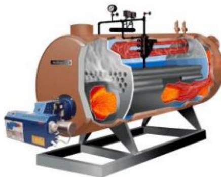
Ilustración 2 "Caldera pirotubular" Fuente: (Barrera, Betoret, Castelló, & Pérez, 2018)
