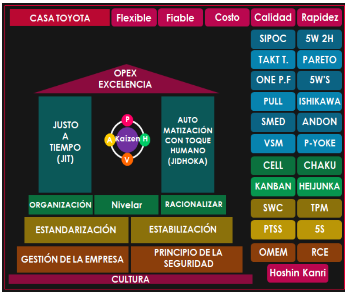
Figura 3. Estructura del sistema lean manufacturing. Información adaptada de (Hernández & Vizán, 2013). Elaborado por las autoras.
