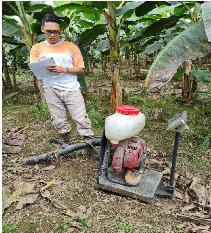
Ilustración 22. Medición del peso de la bomba de fumigación de motor
