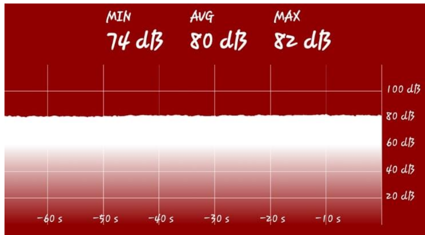
Ilustración 9. Medición de la generación de ruido de la bomba de riego a 20 m de distancia
