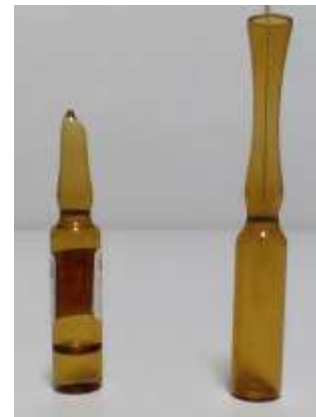
Envases utilizados para recolectar el destilado aceite esencial-agua y el aceite esencial puro, antes y después de purificarlo y deshidratarlo con Sulfato de Sodio.
