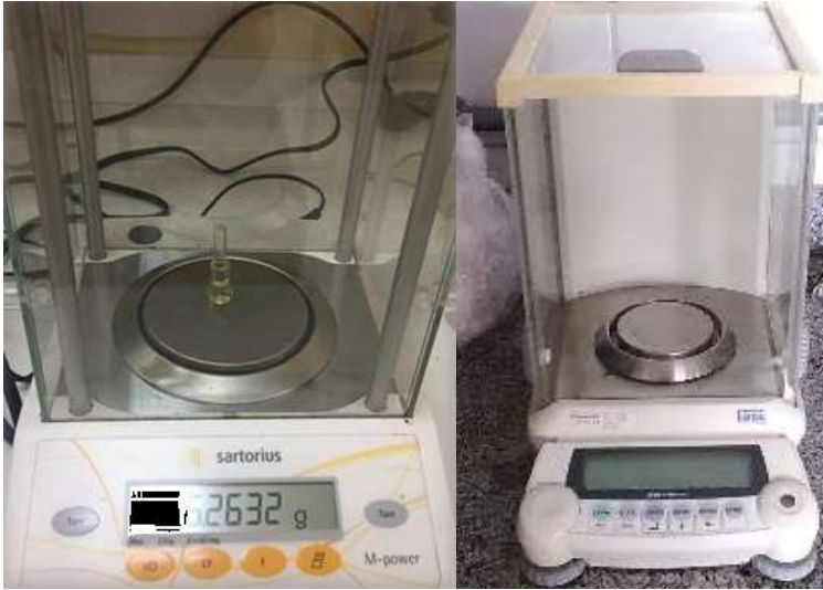
Figura 18 Equipos usados para determinar la densidad y el peso del aceite esencial extraído
