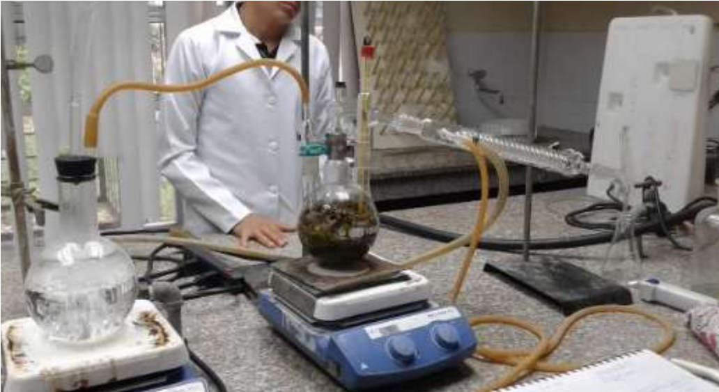
Proceso de hidrotresilación destilación por arrastre de vapor de aceite esencial de la Taraxacum officinale
