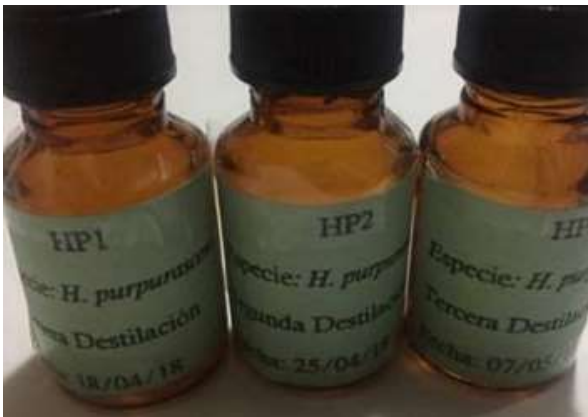
Envases utilizados para recolectar el destilado aceite esencial-agua y el aceite esencial puro, antes y después de purificarlo y deshidratarlo con Sulfato de Sodio.
