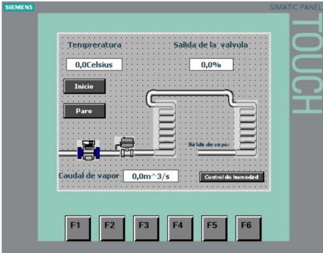
Ilustración 17 Control de Temperatura de 23 a 32 °C
