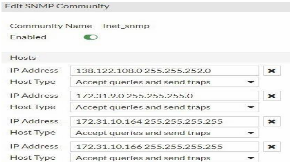
Ilustración 128: En Fortinet realizamos la configuración de la IP del LibreNMS y configuramos la comunidad.
