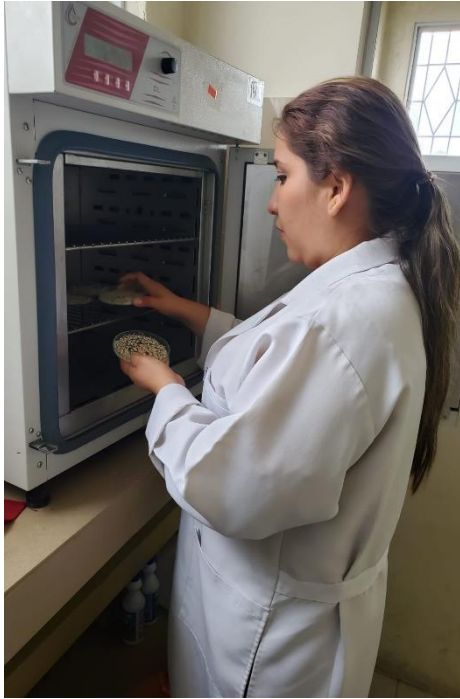
Figura 8.se deja la muestra en la estufa a 50 °C por 10 horas
