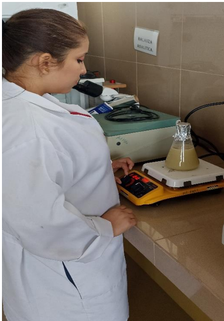
Figura 5. Obtención de pectina por hidrolisis acida. Cantillo, 2023
