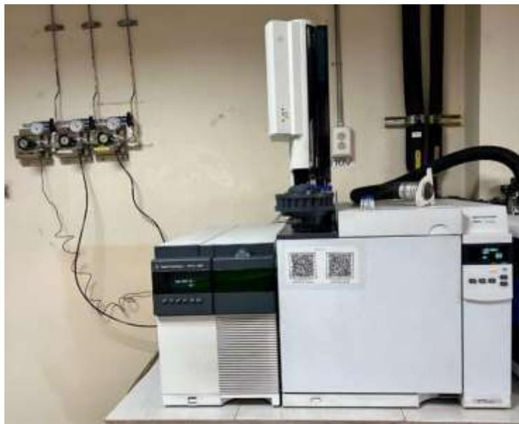
*Anexo 12. Cromatógrafo de gases modelo Agilent 7820A.*
