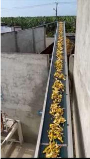
Anexo 1. Canal de salida de la cáscara de banano de la línea de producción.
