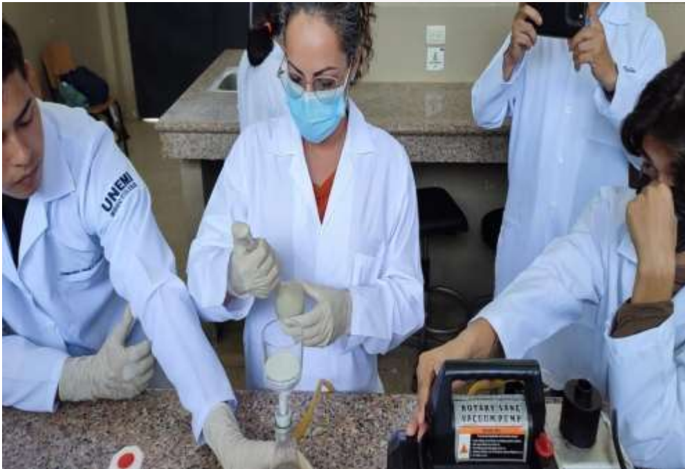
Anexo 1; Filtrado al vacío, para extracción de nano partículas
