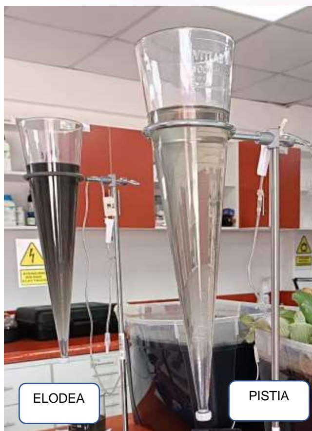
Figura 12. Sólidos sedimentables en TRH 15
