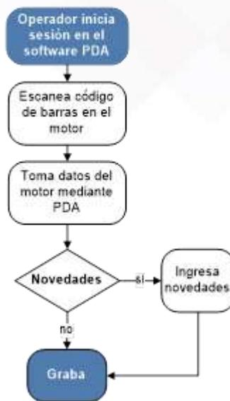
Figura 9. Diagrama de Flujo de toma de datos
