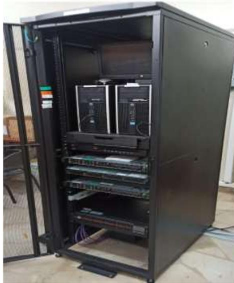
*Figura 7. Servidor del sistema de adquisición de datos industriales en línea.*
