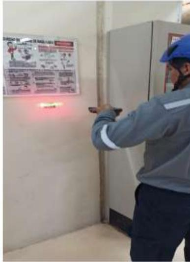
*Figura 15. Escaneo de código de barra con dispositivo PDA*
