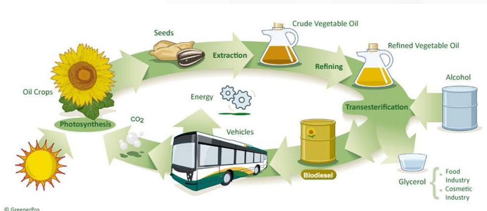
*Nota:* La imagen el proceso de producción de biocombustibles de primera generación, elaborado por (WTS Energy, 2025).
