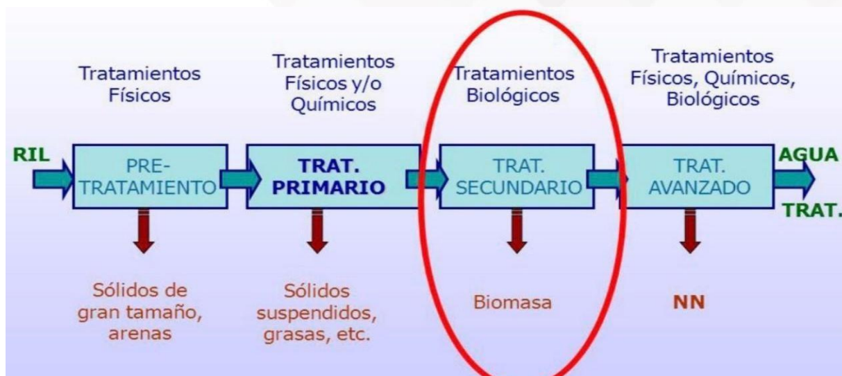
Ilustración 5 Esquema de tratamiento de aguas residuales.
