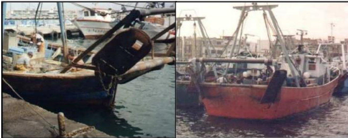
FIGURA 3: Puerta Deflectoras colgadas del pórtico vistas desde la popa
