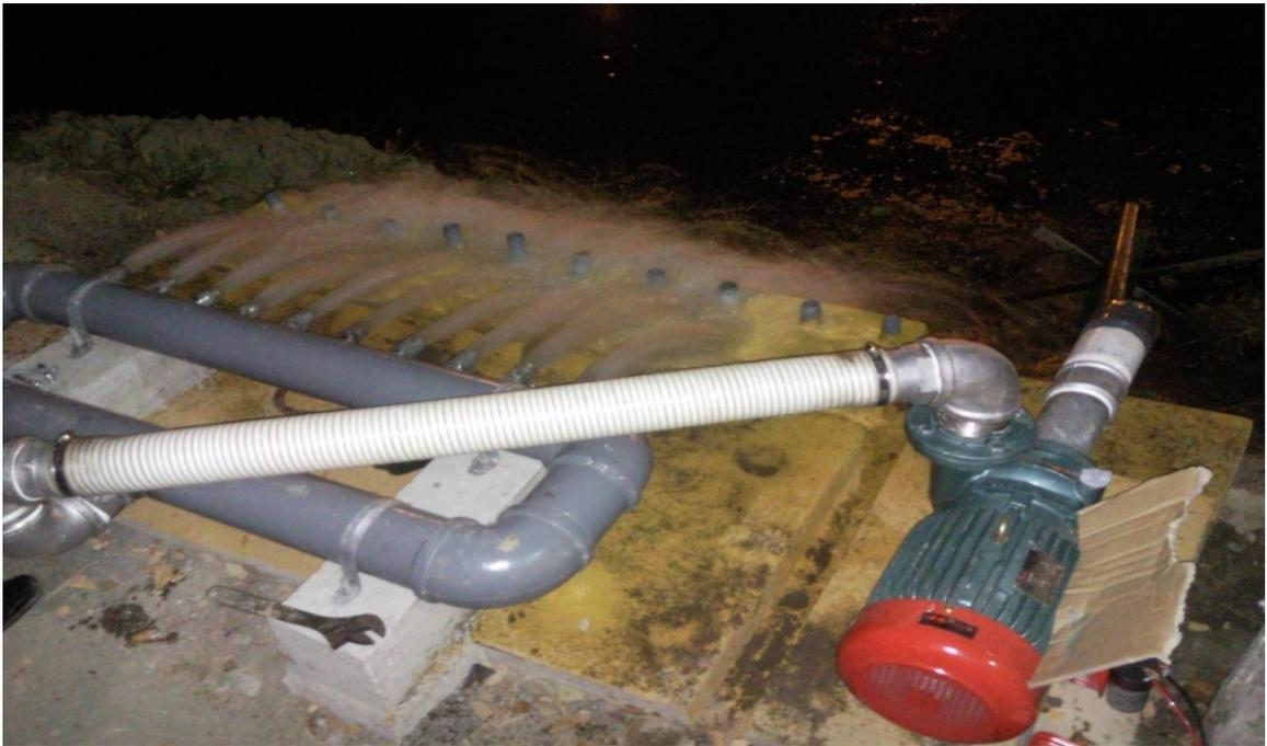
**Figura 31.** Prueba hidrostática.
