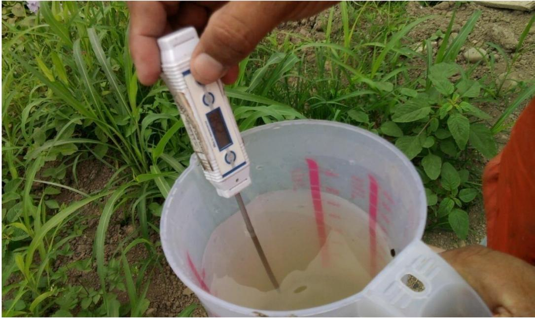
**Figura 21.** Prueba de potencial de hidrógeno (PH).
