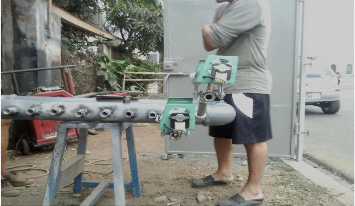
**Figura 29.** Construcción del distribuidor (MANIFOLD).
