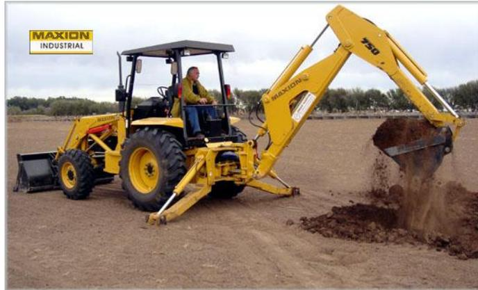
**FIGURA 7.** Equipo auxiliar Retroexcavadora
