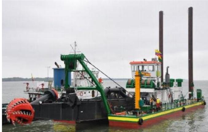
**FIGURA 1.** Draga de succión y cortador
