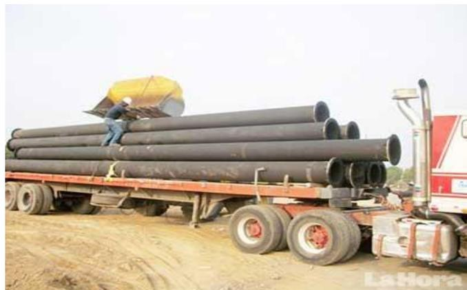
**FIGURA 6.** Tubería de descarga de 20 pulgadas
