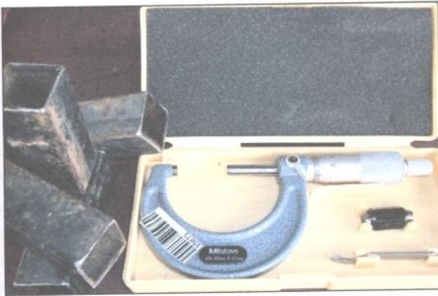
Foto 18. Micrómetro de 25-50mm 0.01mm para medición de las piezas a galvanizar.
