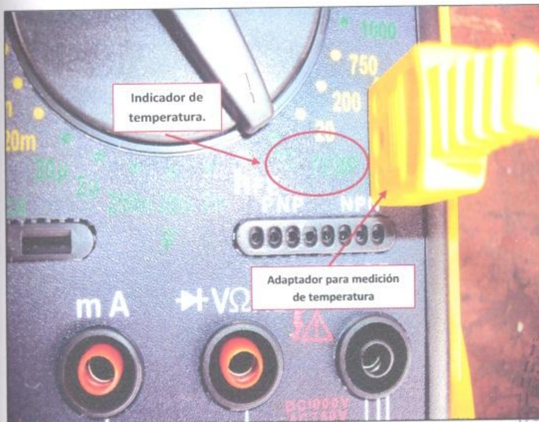
Foto 10. Indicador digital DT-5808 – adaptador de medición.
