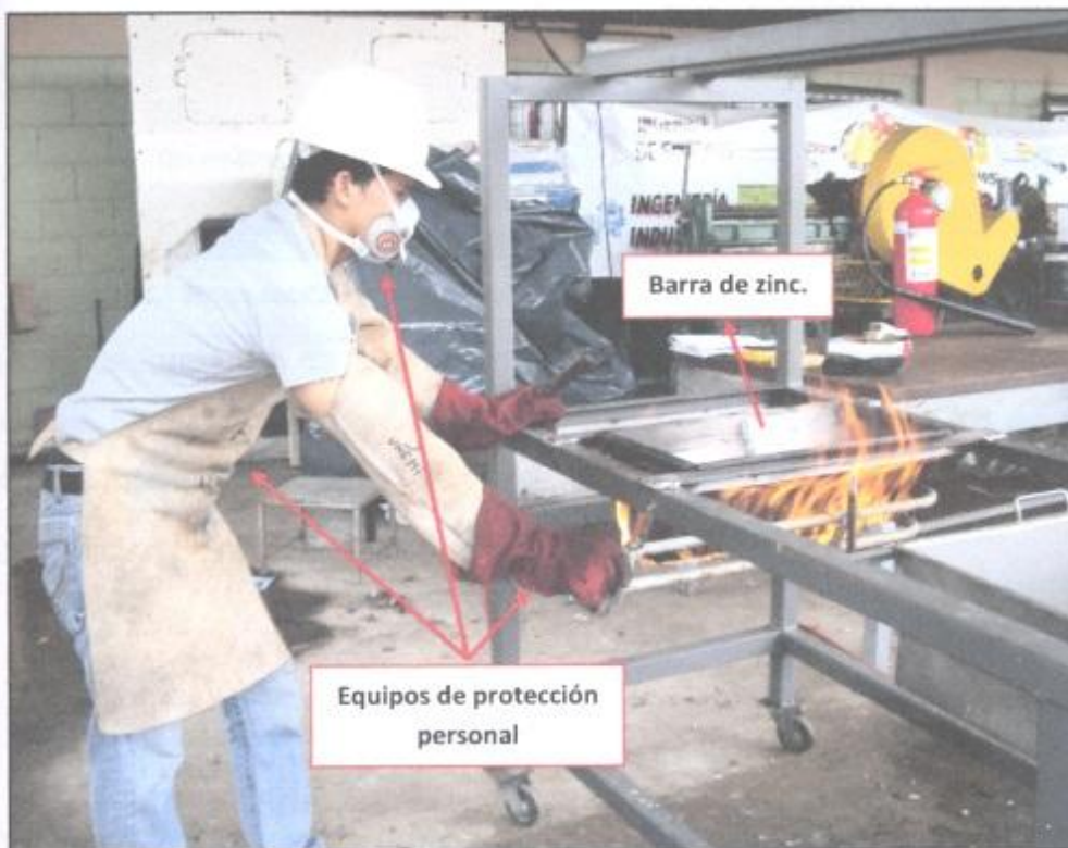
Foto 7. Cuba para galvanizado - Baño de zinc fundente.
