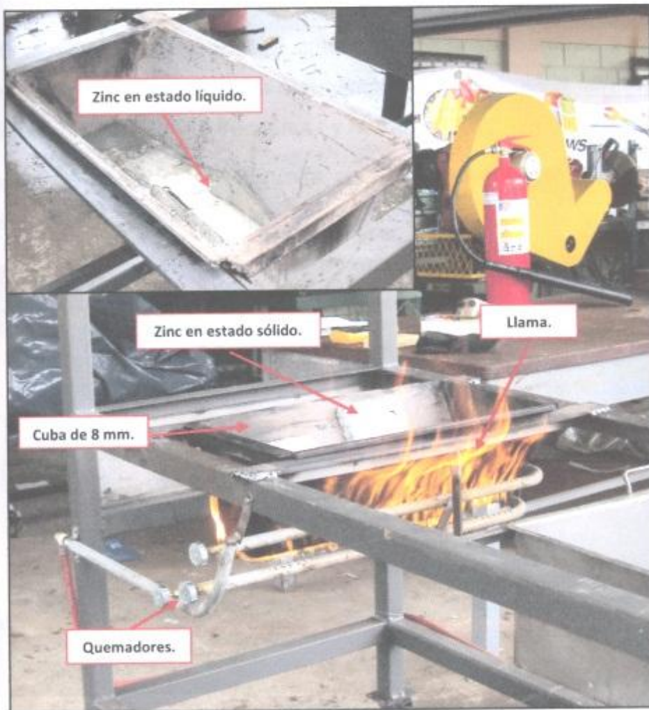
Foto 8. Preparación de la cuba con zinc previo al proceso de galvanizado.
