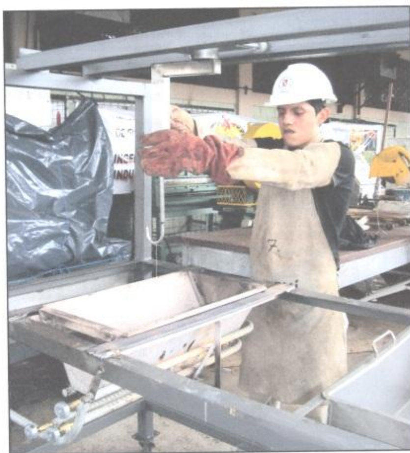
Foto 14. Inmersión de la varilla corrugada de 1/8" en el baño de zinc.
