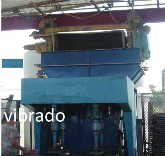
**Figura 40.** Llenado y vibrado
