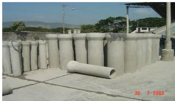
**Figura 44.** Curado y secado
