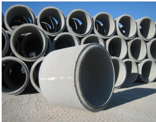
**Figura 15.** Tubos circulares de hormigón simple corriente clase A
