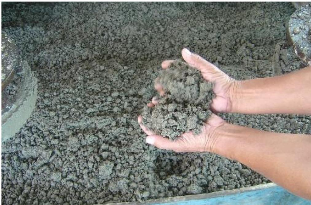
**Figura 37.** Hormigón listo para usarse
