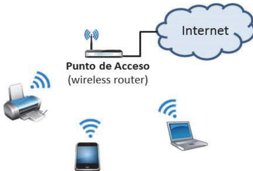
Figura 4. Esquema de una WLAN en el hogar Tomado de (Zalazar Jordie, 2016)
