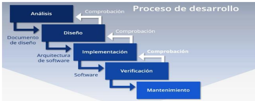
Figura 4: Modelo Cascada (IONOS, 2019).
