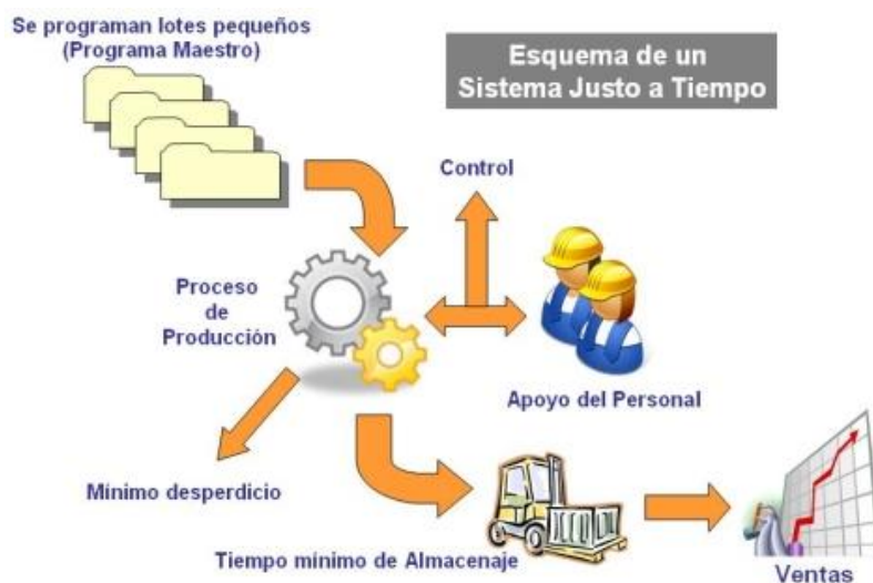
Figura 4. Esquema del sistema Justo a Tiempo.
